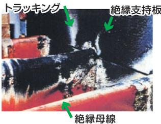
スリットギヤでのトラッキングによる火災 (例)
